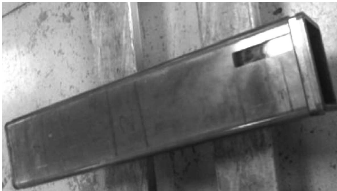
شکل ۲ - قالب آسیب دیده با مقطع مربعی
